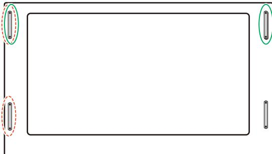
**実線：** 横型設置時落下防止用ワイヤー取り付け可能ハンドル
