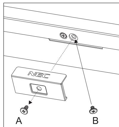
取り付け方法：取り外したネジで NEC ロゴオーナメントを固定します。
