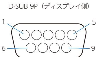
ディスプレイは RS-232C の制御に RXD、TXD、GND を使用します。
