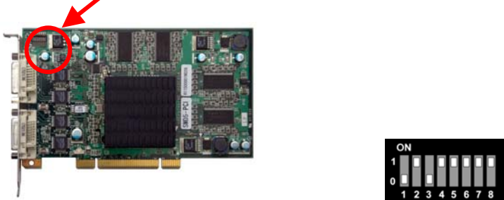
図 3.2-1MD-SMD-PCI ボード表面とディップスイッチ初期設定
