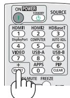
Si le projecteur peut être utilisé avec l'ID de télécommande actuel, [Actif] s'affichera. Si le projecteur ne peut pas être utilisé avec l'ID de télécommande actuel, [Inactif] s'affichera. Pour faire fonctionner le projecteur inactif, attribuez l'ID de contrôle utilisé pour le projecteur en suivant la procédure suivante (étape 3).
