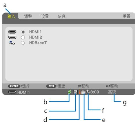
a: 高亮 / b: 光源模式符号 / c: 高海拔符号 / d: 温度计符号 / e: 键锁符号 /
