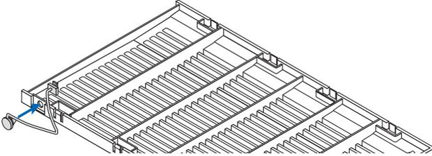
2. 将过滤网盖带子另一端的方形凸起插入至投影机机身上的孔中，然后将带子旋转90°用于固定。如果取下过滤网一次，固定带子会变得容易。
