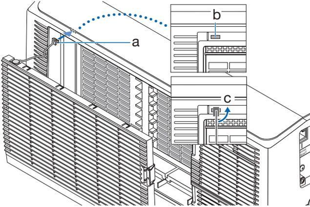
a: 方形凸起 / b: 用于固定带子的孔 / c: 旋转带子90°
