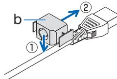
3. 将电源插头插入 AC IN 端子，直至电源线固定器完全固定且听到咔哒声。
