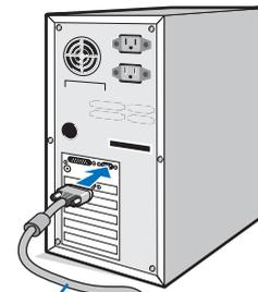
Signalkabel mit 15-poligem Mini-D-SUB-Stecker
