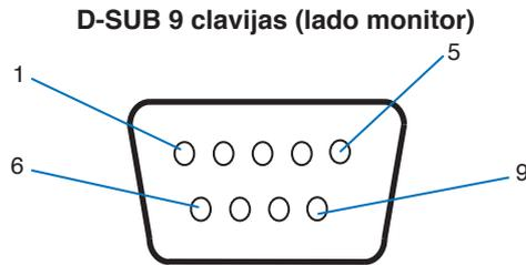
Este monitor utiliza líneas RXD, TXD y GND para el control de RS-232C.
