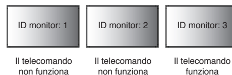
Figura 2 Configurazione del telecomando per utilizzare ID TELCOMANDO:3
