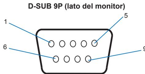
Questo monitor utilizza linee RXD, TXD e GND per il controllo tramite RS-232C.
