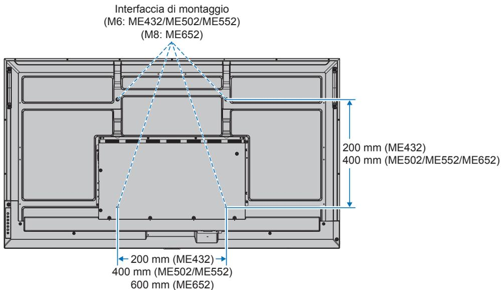
Gli accessori di montaggio possono essere fissati con il monitor rivolto in basso. Per evitare di graffiare il pannello LCD, posizionare sempre sul tavolo un panno morbido, come un telo più grande dell'area dello schermo del monitor, prima di collocare il monitor con lo schermo verso il basso. Accertarsi che sul tavolo non vi sia nulla che possa danneggiare il monitor.
