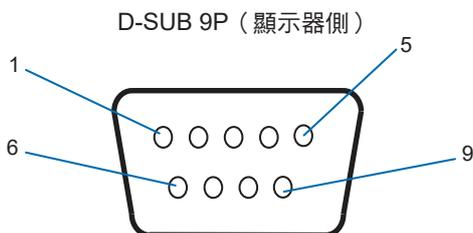
本顯示器使用RXD、TXD和GND線路進行RS-232C控制。
