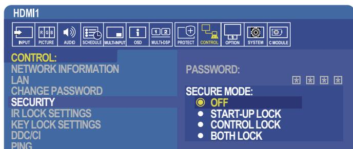
1. 使用IR遙控器導航到[控制 (控制)]，然後到[安全 (安全)]。
