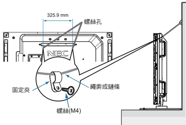
將液晶顯示器安裝到牆上前，請確保牆壁能夠支撐顯示器的重量。
