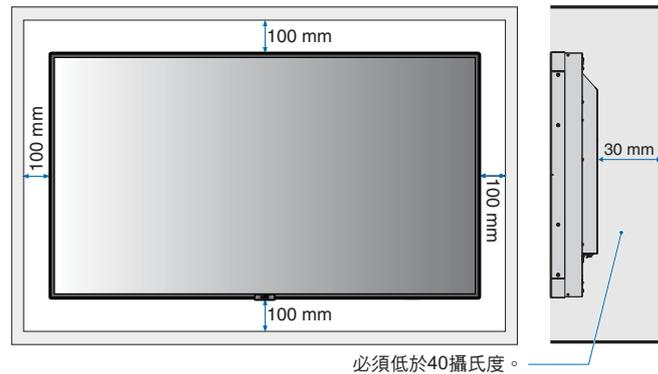
注意： 確保顯示器周圍通風良好或安裝空調器，以便顯示器和安裝裝置正常散熱；尤其是在多屏配置下使用顯示器時。
