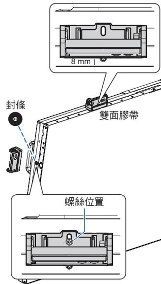
**用螺絲固定：**取下覆蓋在邊框螺絲孔上的封條。使用附帶的螺絲固定感應器單元。
