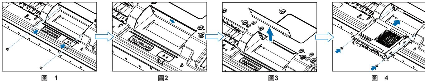
4. 將選配板卡插入顯示器並使用拆下螺絲將其固定到位（圖4）。（推薦緊固力：139 - 189 N•cm）。
